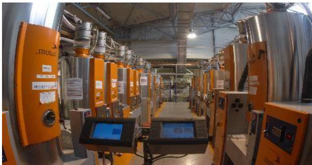
Alimentarea centralizată cu granule a mașinilor de injectat
